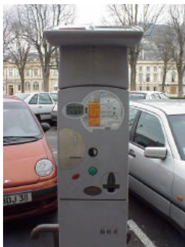
Un parcmètre collectif fonctionnant à l'énergie solaire
